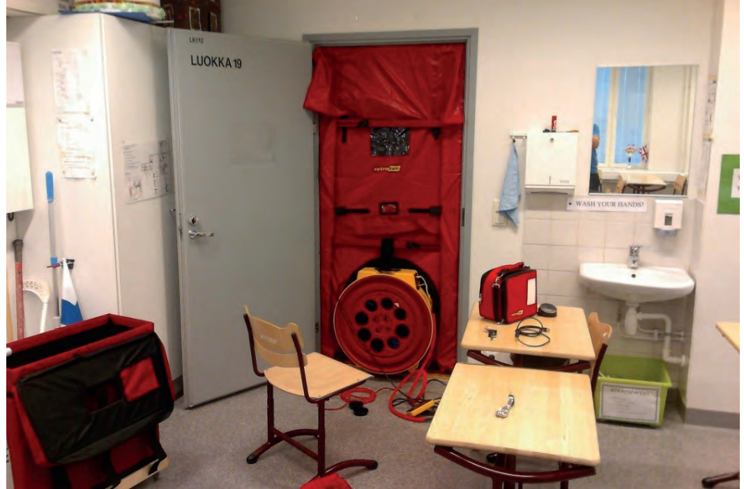
Luokan merkkiainemittaukseen käytettävä alipaineistuspuhallin
