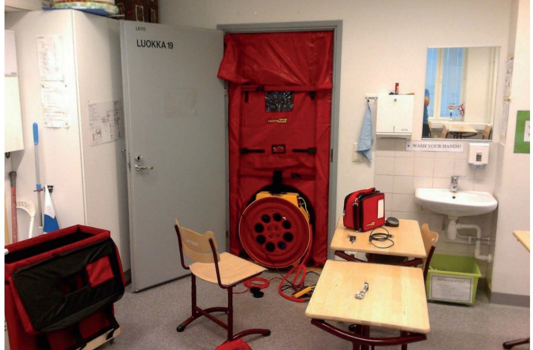
Luokan merkkiainemittaukseen käytettävä alipaineistuspuhallin
