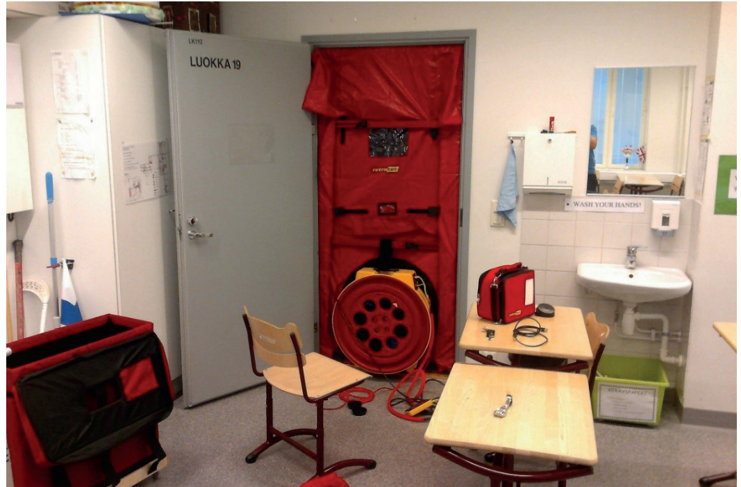
Luokan merkkiainemittaukseen käytettävä alipaineistuspuhallin
