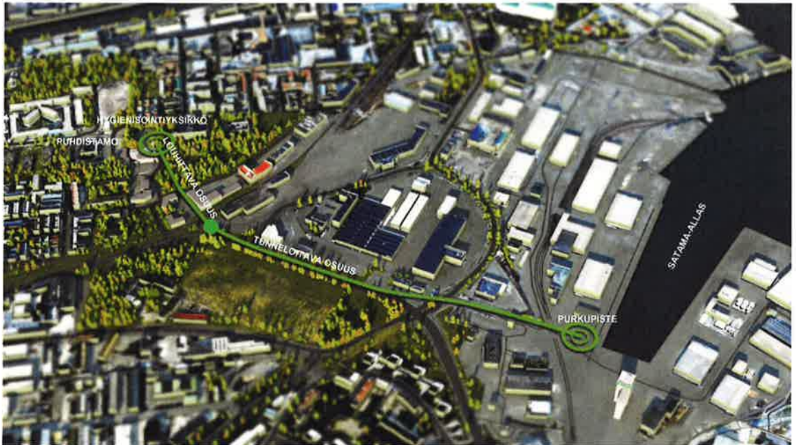
KUVA. Poistoputken reitti puhdistamolta purkupisteeseen satama-altaaseen.
